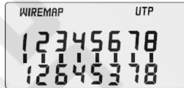
Результат при перекрещивании линий «3» и «6» кабеля RJ45
