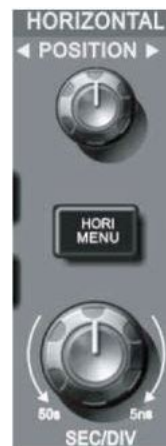
Рисунок 1-7. Зона управления горизонтальной разверткой на панели управления
