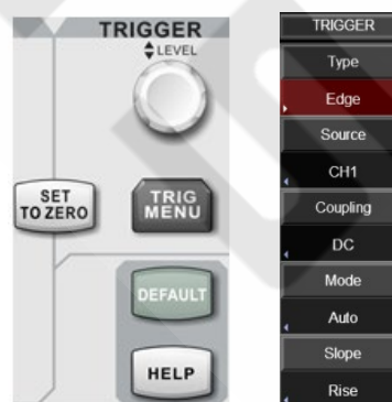
Рисунок 1-8. Зона управления запуском на панели управления и меню настройки запуска
