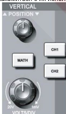
Рисунок 1-6. Зона управления вертикальной шкалой на панели управления
