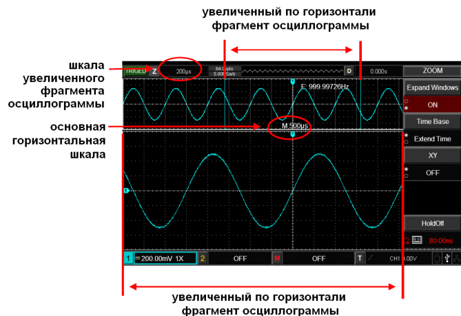
Рисунок 3-2. Фрагмент осциллограммы, растянутый по горизонтальной оси
