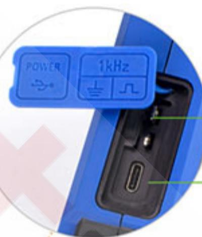
Выходной сигнал для компенсации пробников (меандр 3.3 В/1 кГц)
