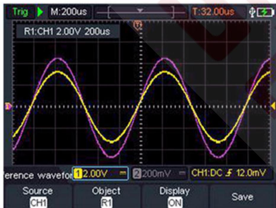
Сохранение в памяти до 4-х вариантов настроек, до 4-х опорных осциллограмм, до 4-х изображений сигналов, до 4-х CSV файлов сигналов.
